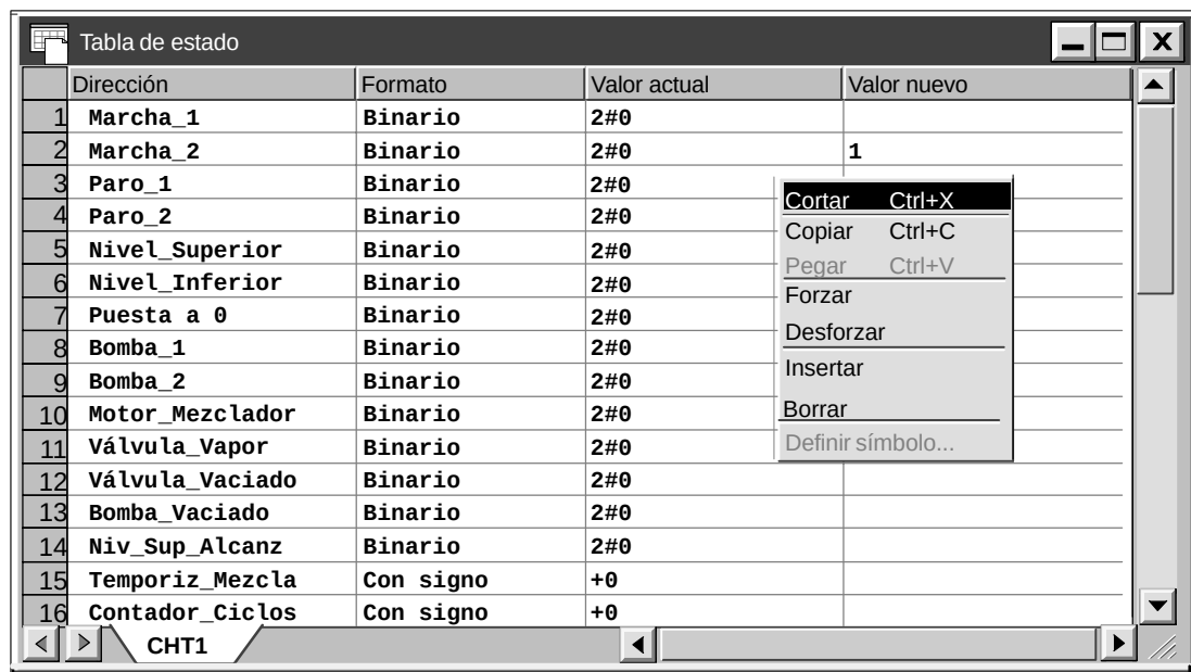
Figura 4-16 Observar y modificar variables con una tabla de estado
