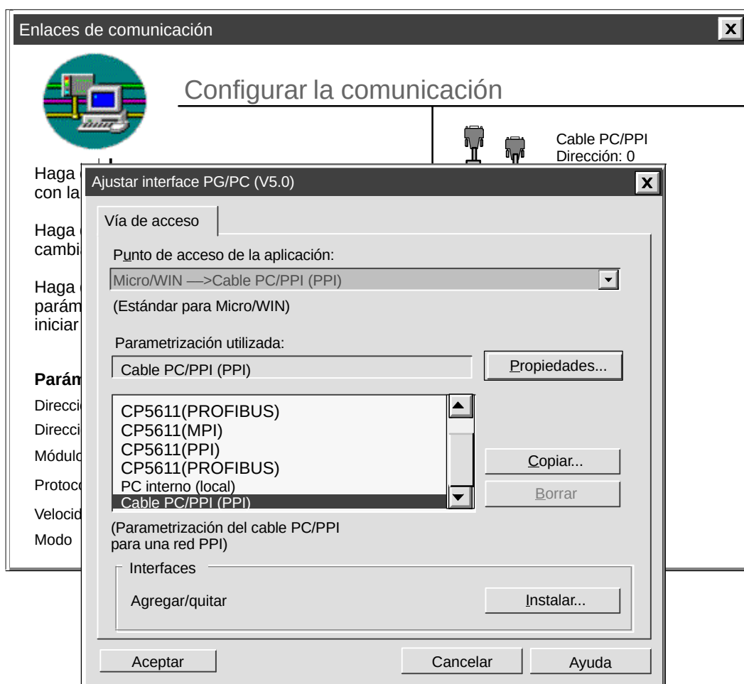
Figura 3-2 Ajustes en el cuadro de diálogo "Interface PG/PC"
